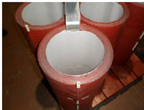
Przykład uzwojenia nN bez kanału. W takim przypadku sonda PT100 zostanie zainstalowana na powierzchni uzwojenia nN, pomiędzy uzwojeniami nN i SN
