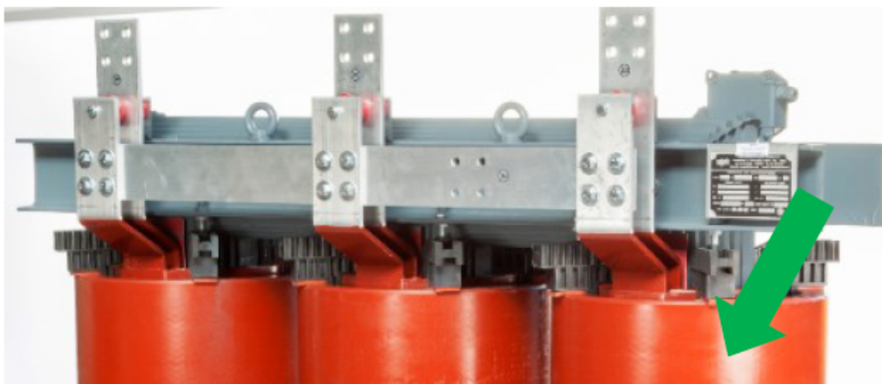
Punkt o najwyższej wartości temperatury uzwojeń nN - znajduje się w przybliżeniu o 25cm poniżej górnej krawędzi uzwojenia nN
